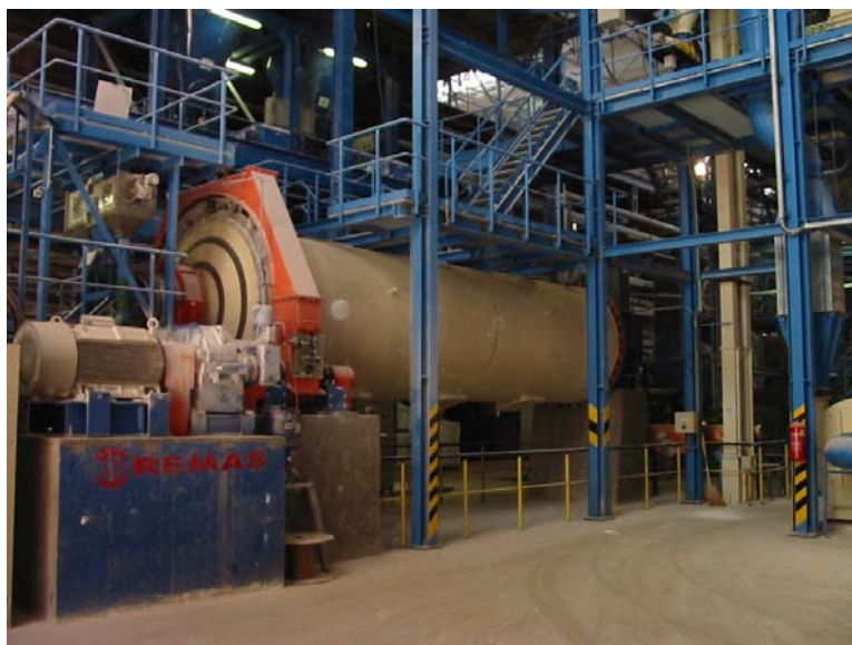
7.2. ábra: Üzemi golyósmalom (MAL Zrt., Ajka)
