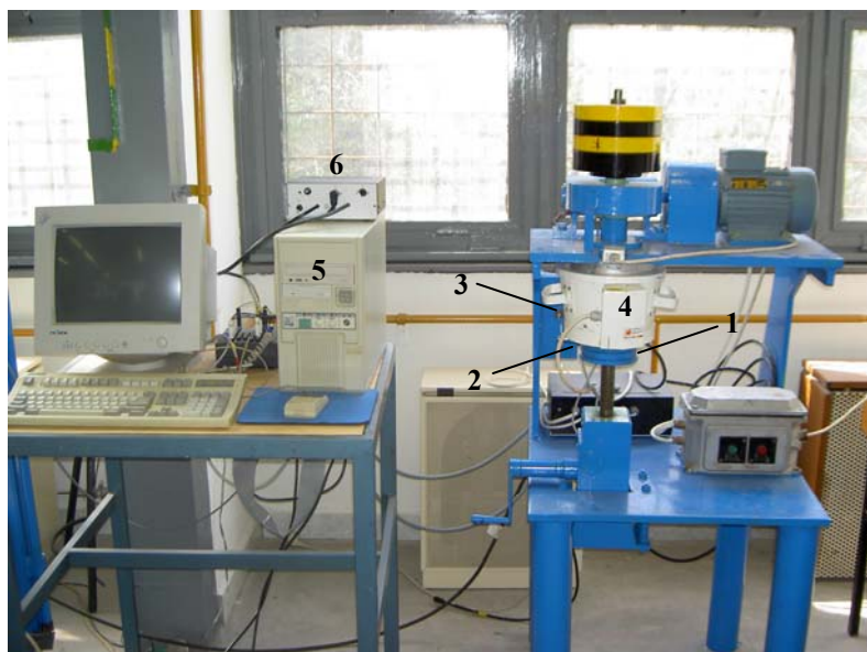
4.5. ábra: Univerzális malom és szabályozó-, mérésadatgyűjtő rendszere (1-nyomcsapágy, 2-erőkar, 3-erőmérő, 4-őrlőtégely, 5-számítógép, 6-jel erősítő)
