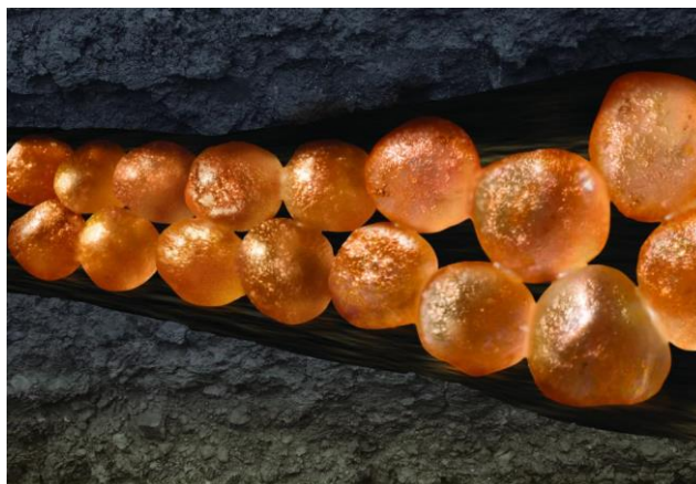
2. Ábra Kitámasztott repedés illusztrációja (Terracina & Harper, 2018)
