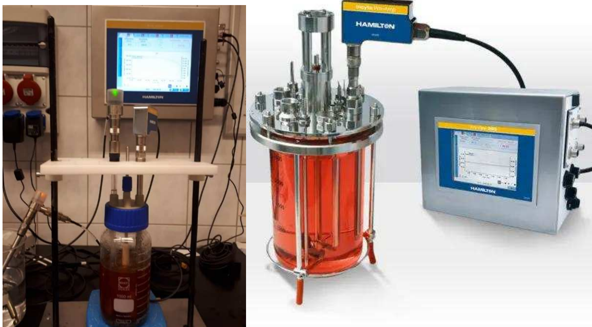
4.5.2. ábra: Kísérleti elrendezés 2 szenzorhelyes reaktorban a laborunkban (balra), Hamilton promóciós fotó [medicalexpo.com] (jobbra)
