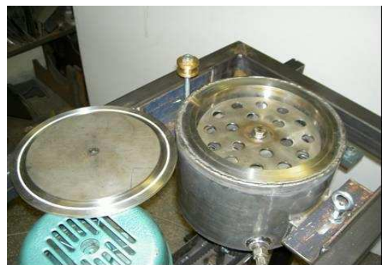
4.1.1. ábra: A fűthető keverőmalom (balra), őrlőtér az acél keverőtárcsákkal (jobbra) saját fotók
