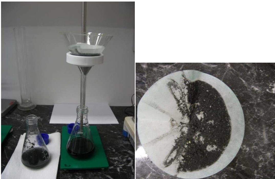
5.2.4. ábra: Kénsavas oldás utáni fázissztválasztás (balra), szilárd maradék (jobbra)
