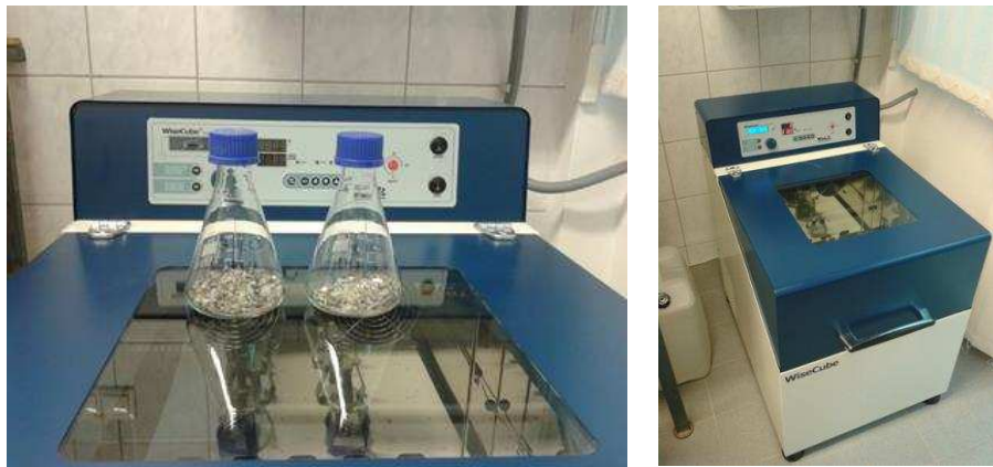
4.1.2. ábra: A kioldási vizsgálatok során használt WiseCube rázógép (saját fotók)
