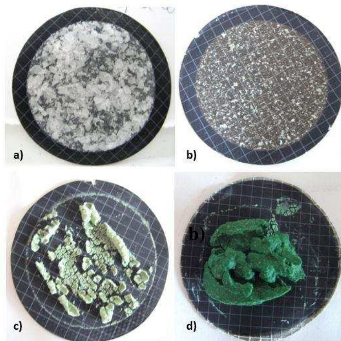
5.2.14. ábra: Az anód kilúgzási oldataiból kiejtett csapadékok: a) pH= 1,26; b) pH=4,24; c) pH= 7; d) pH=11,05
