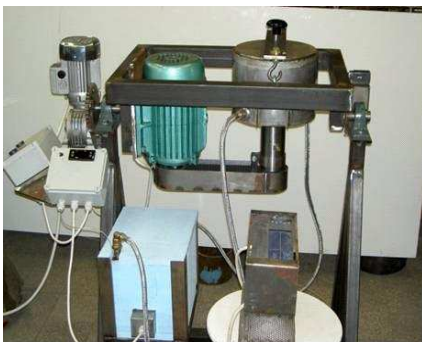
4.1.1. ábra: A fűthető keverőmalom (balra), őrlőtér az acél keverőtárcsákkal (jobbra) saját fotók
