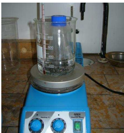
5.3.1. ábra: 80°C-on végzett kioldási vizsgálat összeállítása
