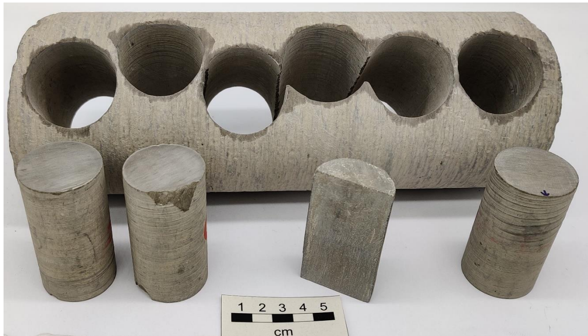
64. ábra. A Hu-1/12 sorozatából kialakított minták és a kifűrés utáni maradék kőzet (sz.s.sz.)
