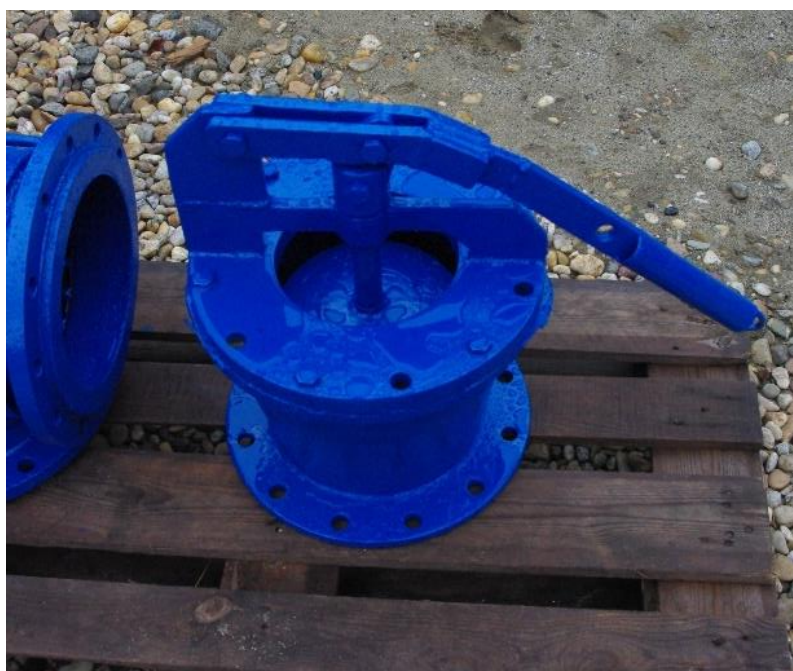
13. ábra: A csáp tisztításához használt szelep (a szerző saját fotója).
