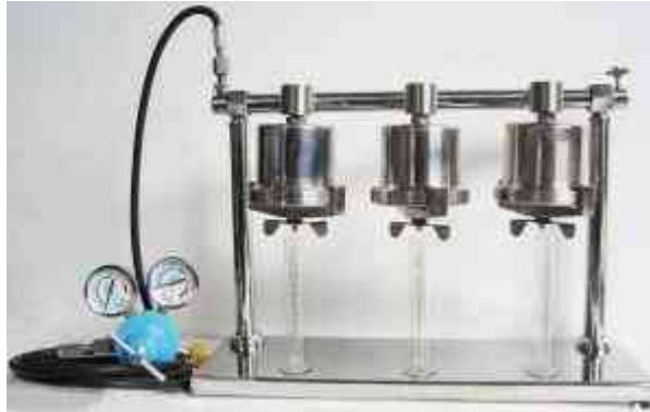
3. ábra: Kiszűrődés-vizsgáló mérőeszköz (Fann; Multi unit Filter Press)
