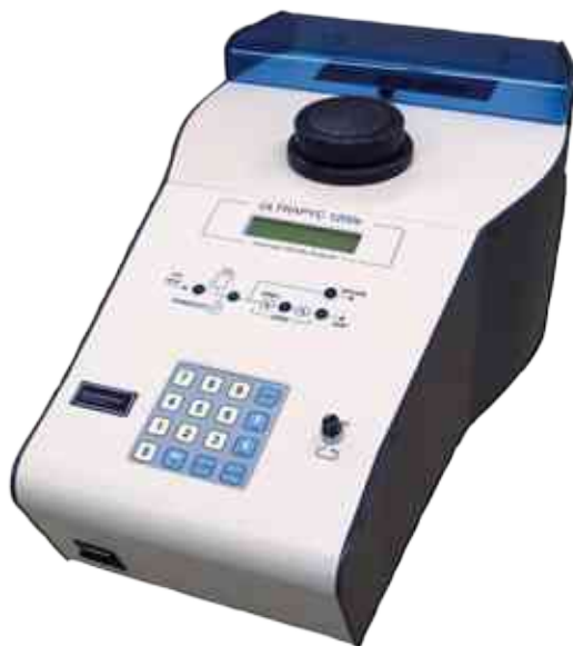
9. ábra: Quantachrome gyártmányú, Ultrapyc 1200e típusú multipiknométer
