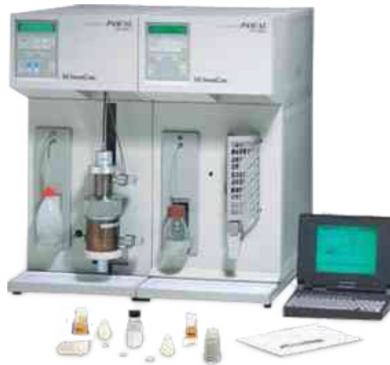
10. ábra: Higanys poroziméter kis- és nagynyomású egységei; ThermoFisher gyártmányú Pascal 140 és 440
