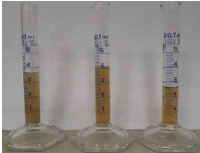
48. ábra: Kumulált szüredék tárolóvédő folyadék vizsgálatakor
