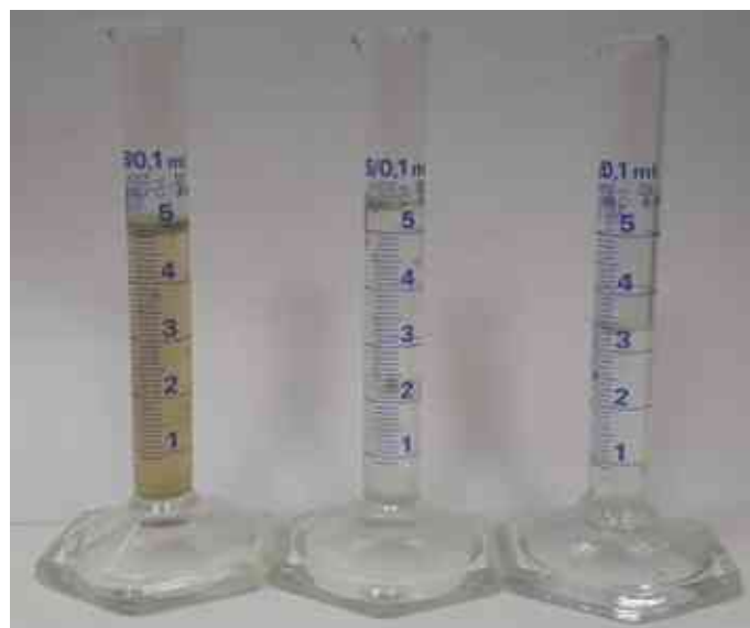
54. ábra: A kis áteresztőképességű kőzetmagon keresztül nyert szüredék
