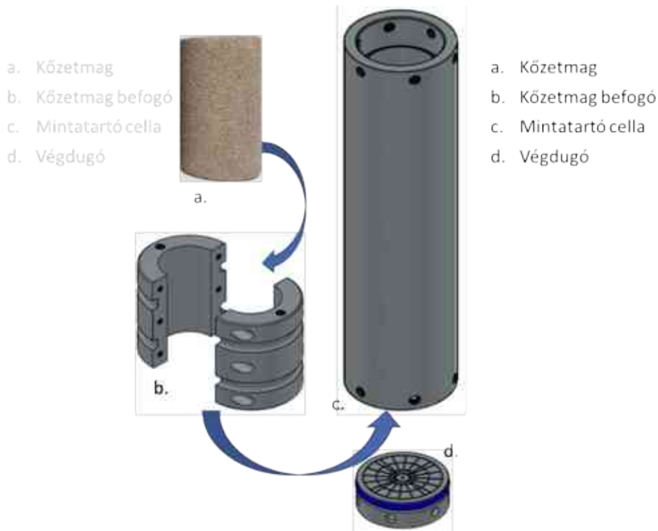
40. ábra: Mérési elrendezés az egyedi gyártású nagynyomású cellában
