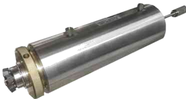
13. ábra: Hassler típusú kőzetmag befogó cella
