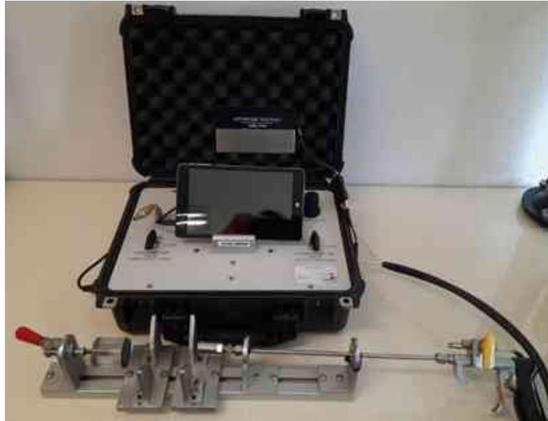
16. ábra: Hordozható permeaméter; Corelab PPP-250
