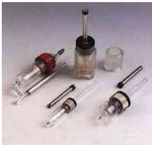
11. ábra: Dilatométer cella, fém armatúrával, fegyverzettel
