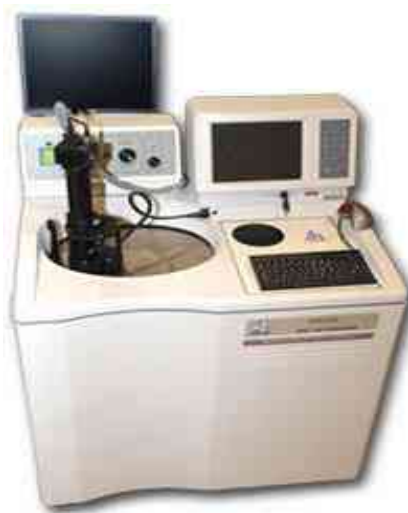
17. ábra: Kőzetcentrifuga; Coretest URC-628
