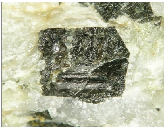
5.2. ábra: Zömök oszlopos turmalinkristály pegmatitban. S6 minta. Képszélesség: 8 mm. Szerző saját szerkesztése.
