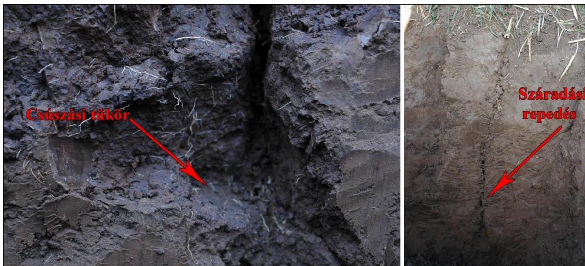
14. 6. ábra. Csernozjom-barna erdőtalajon (vertisol) kialakult csúszási tükrő és száradási repedés (Tard).
