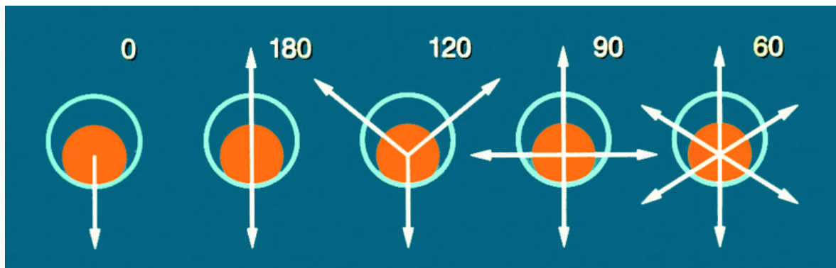
2-6 ábra: Perforációs kialakítás lehetséges fázisszögei ( petrowiki.spe.org, 2013 )
