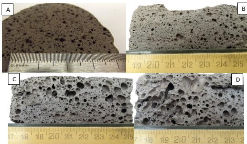
34. ábra Nyers lignit pernye alapú geopolimer habok (A: habosítószer nélküli, B: 0,5 m/m% H 2 O 2 , C: 1 m/m% H 2 O 2 , D: 3 m/m% H 2 O 2 )
