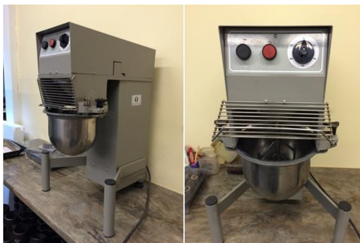
9. ábra Függőleges tengelyű keverőgép
