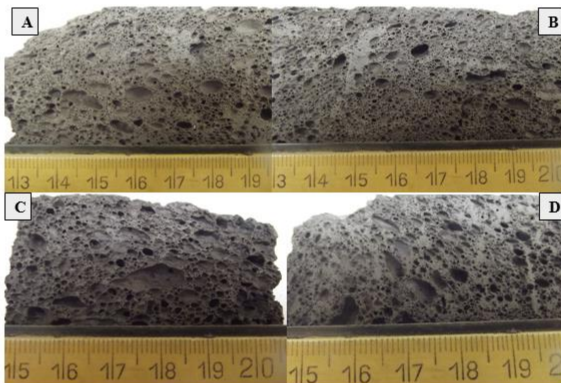
40. ábra Geopolimer habmintákról készült képek ( SSA_{\text{pernye}} : A. 2016 \text{ cm}^2/\text{g} , B. 2134 \text{ cm}^2/\text{g} , C. 2481 \text{ cm}^2/\text{g} , D. 3599 \text{ cm}^2/\text{g} )
