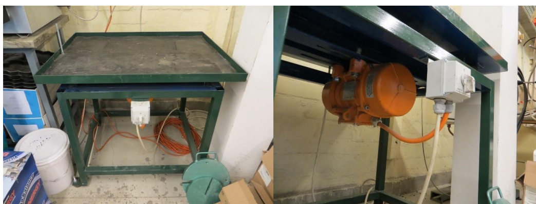
10. ábra Laboratóriumi vibrációs asztal
