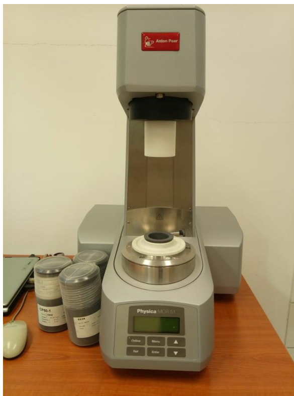
16. ábra Anton Paar Physica MCR 51 rotációs reométer
