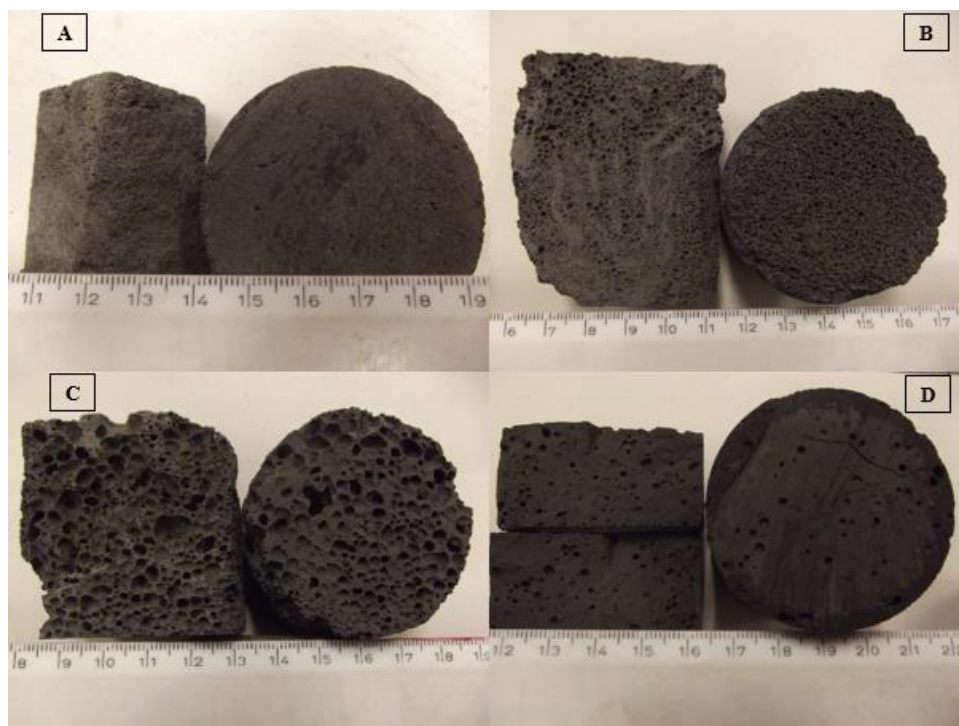
59. ábra Geopolimer habmintákról készült képek ( SSA_{\text{pernye}} : A. 1232 \text{ cm}^2/\text{g} , B. 1769 \text{ cm}^2/\text{g} , C. 2274 \text{ cm}^2/\text{g} , D. 10284 \text{ cm}^2/\text{g} )
