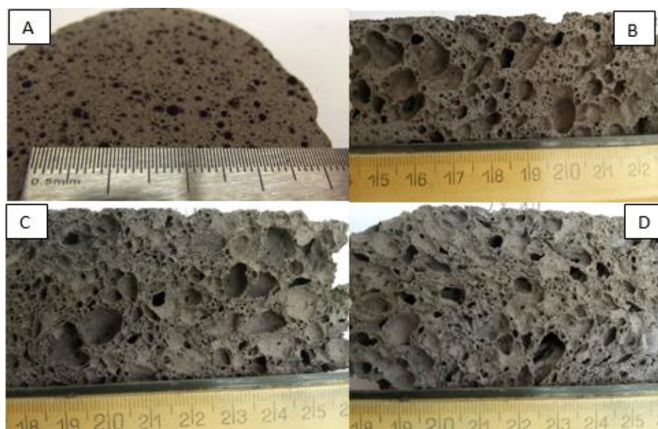
31. ábra Nyers lignit pernye alapú geopolimer habok (A: habosítószer nélküli, B: 0,25 m/m% Al por, C: 1 m/m% Al por, D: 2 m/m% Al por)
