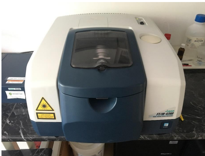
17. ábra JASCO FT-IR 4200 spektrométer
