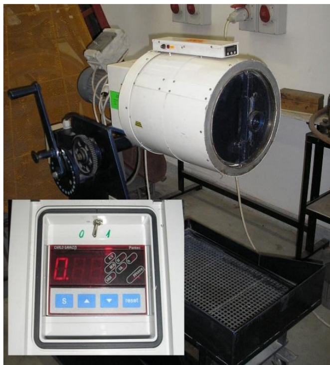
12. ábra Laboratóriumi golyósmalom
