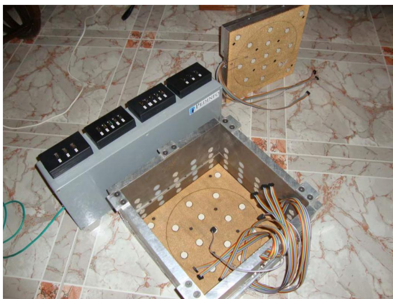
4-18. ábra: Nyomásszenzoros mérőrendszer a nagyméretű nyíróberendezéshez (Pedinfo Kft.)
