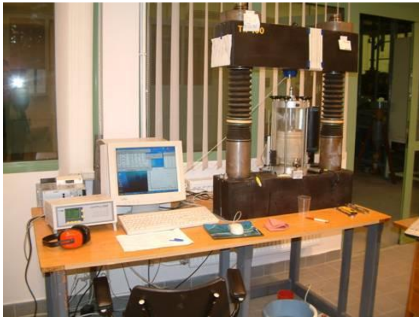
4-7. ábra: Triaxiális vizsgáló berendezés a Miskolci Egyetem, Geotechnikai Talajvizsgáló Laboratóriumában
