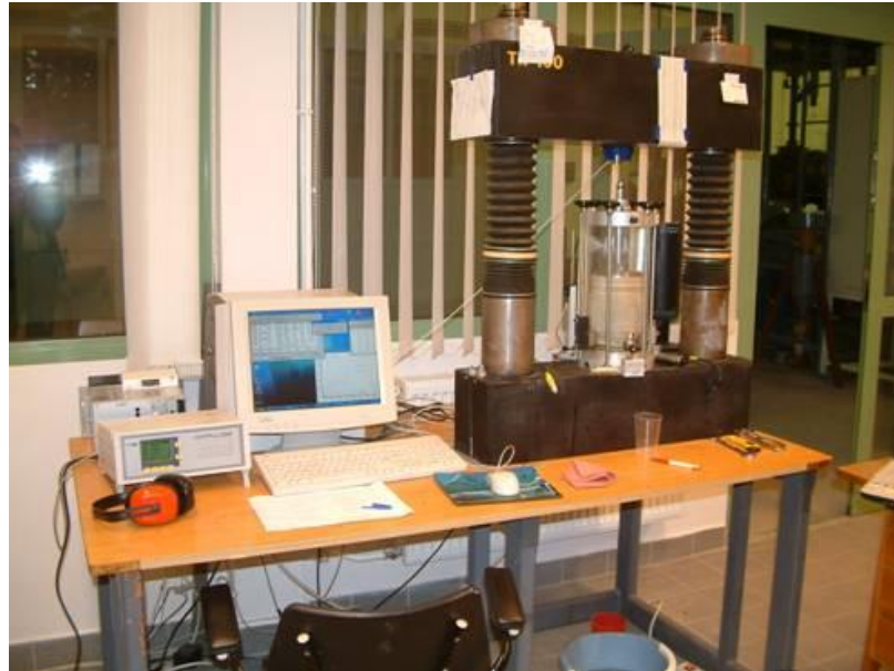
2-3. ábra: Triaxiális vizsgáló berendezés a Miskolci Egyetem, Geotechnikai Talajvizsgáló Laboratóriumában
