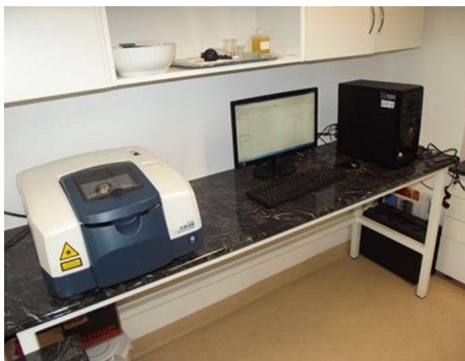
34. fotó. Fourier-transzformációs infravörös spektroszkóp, reflexiós – ATR-FTIR (Fotó: Molnár Zoltán)
