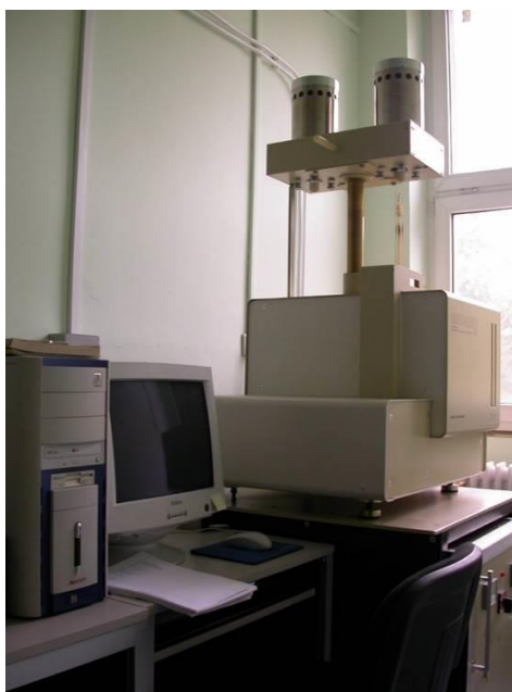
32. fotó. MOM Derivatograph-C, termoanalitikai mérőműszer. Max. 1100 °C, 5°C/min, 10 °C/min, 20 °C/min; 0,05-0,5 g minta, levegő, CO 2 , N 2 . (Fotó: Kristály Ferenc)
