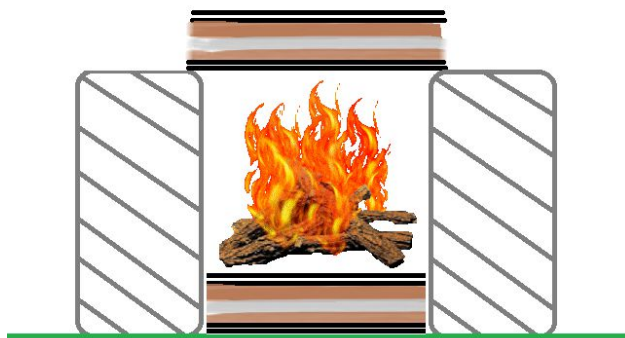
38. ábra. Avasi limnoszilit mintákon végrehajtott sütési kísérlet felépítésének vázlatos rajza.
