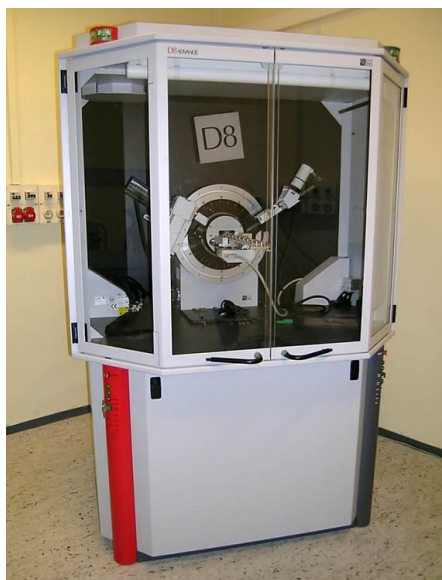
31. fotó. Bruker D8 Advance (Cu-K \alpha sugárzás, 40 kV-40 mA generátor menet) röntgenpordiffrakciós (XRD) készülék (Fotó: Kristály Ferenc)
