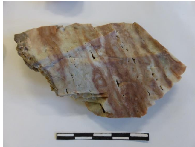
30. fotó. Enyhén vöröses színbe fordult avasi limnoszilit, laboratóriumi hőkezelő kemencében 260 °C után 360 és 500 °C-on hőkezelve. Mivel az első hőkezelés során a minta pórusaiból és szövetszerkezetéből minden víz távozott, így a nyersanyag a magasabb hőfokú hőkezelések során sem repedt el.
