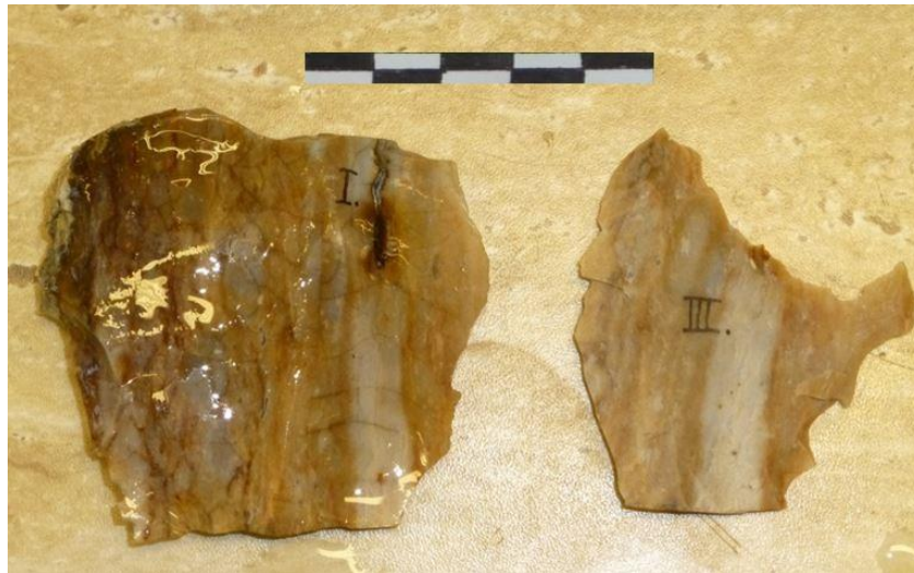
29. fotó. „Hőingadozás” laboratóriumi kísérlet eredménye: jól megfigyelhető a baloldali mintán keletkezett, rácsos szerzetű repedésháló.
