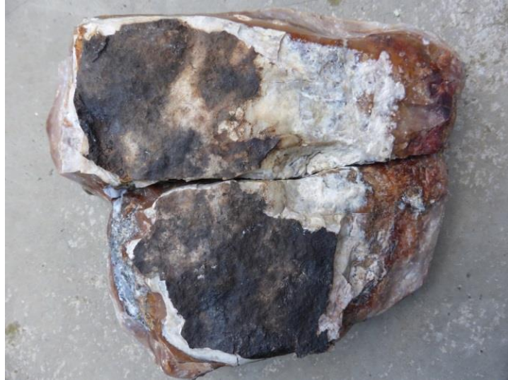
16-19. fotók. Sütési kísérlet. A szétpattant, ép, de helyenként termikus stigmákat mutató felső padminta.
