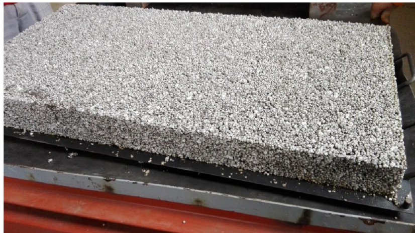
7.15. ábra: Az elkészült geopolimer-EPS kompozit próbatest
