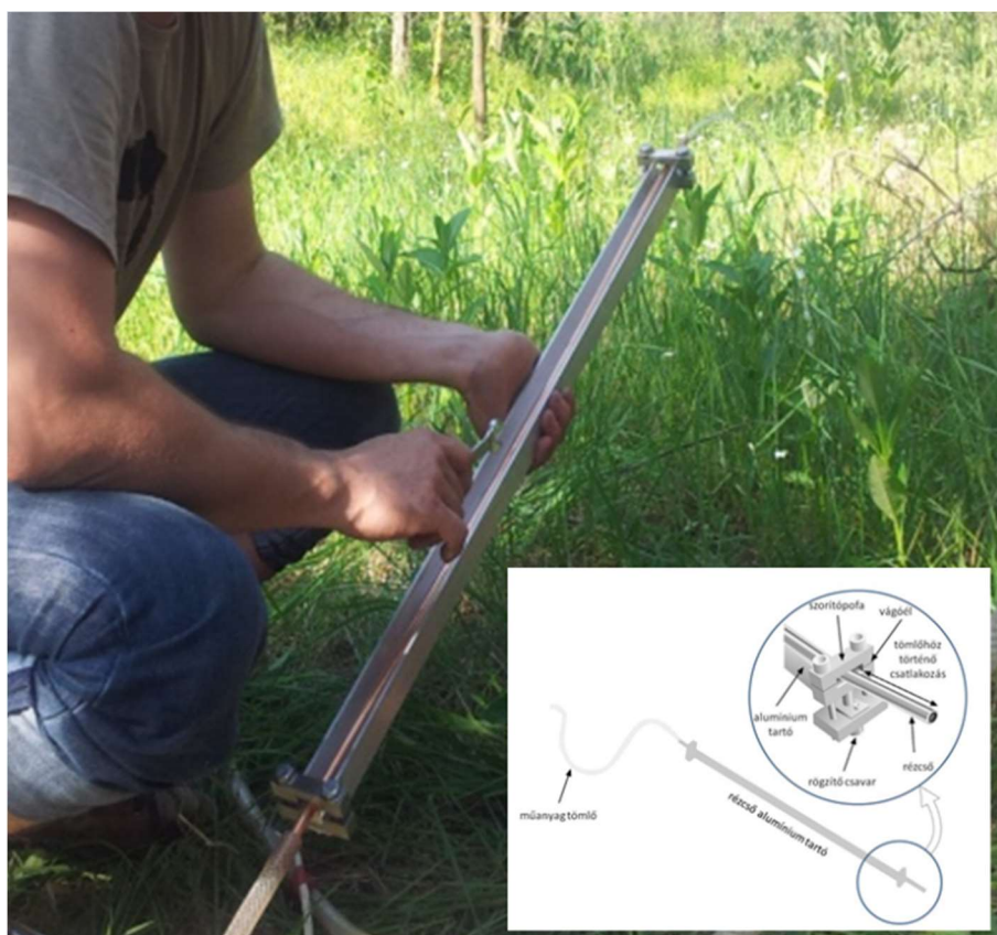
5-1. ábra Rézcsöves vízmintavétel nemesgázokra (saját fotó és szerkesztés (Aeschbach-Hertig W. nyomán))
