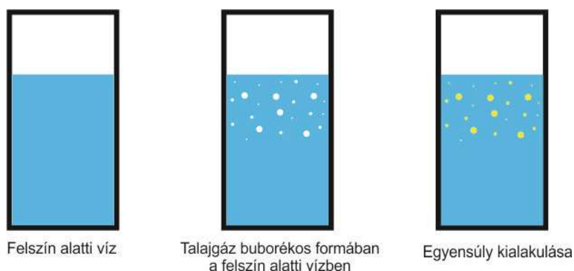
8-2. ábra A kigázosodás mechanizmusának modellje zárt rendszerben
