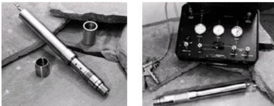
13. ábra A ConeSipper mintavevő két fő egysége ( Internet_9 ).
