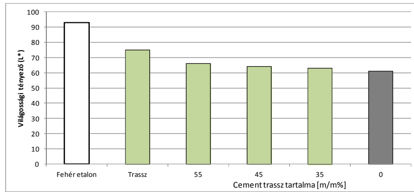
62. ábra: A fehér etalon, a trassz, valamint a különböző mennyiségű trasszot tartalmazó cementek világossági tényezője ( L^* )
