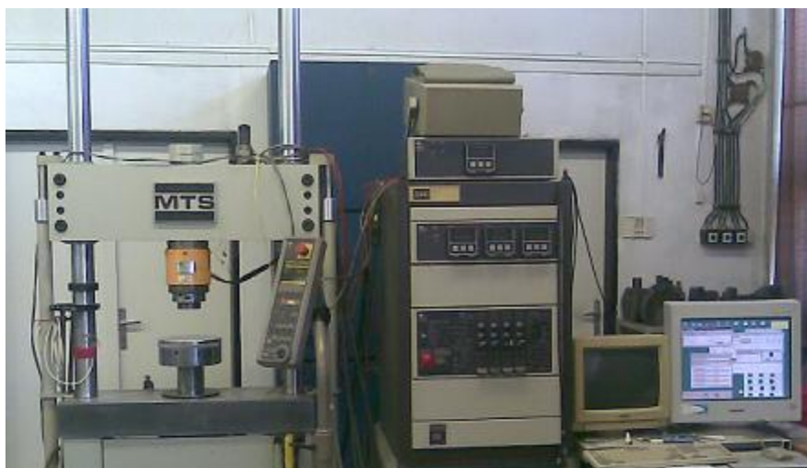
3.3. ábra. Hidraulikus törőgép, kiértékelő berendezés
