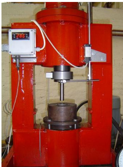
3.2. ábra. Hidraulikus brikett-prés
