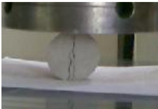
4.15. ábra. Tabletta törés közben
