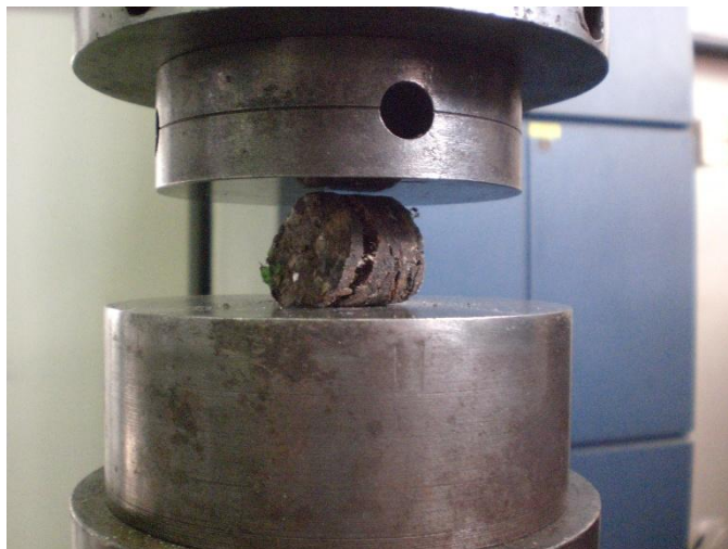
5.16. ábra. Brikett deformálódása és törése
