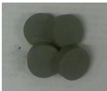
4.3. ábra. Szilícium karbid brikettek (átmérő: 25 mm, magasság 9 mm)
