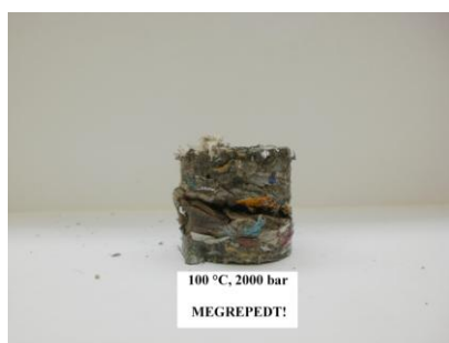
5.11. ábra. 200 MPa-on készült tabletta (100 °C)
