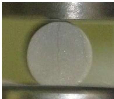
3.4. ábra. SiC tabletták törése
