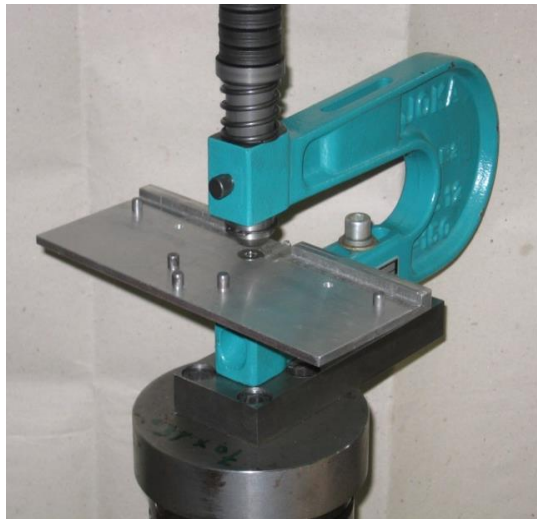
9. ábra. A kísérleti klincselő szerszám a befogó készülékkel
