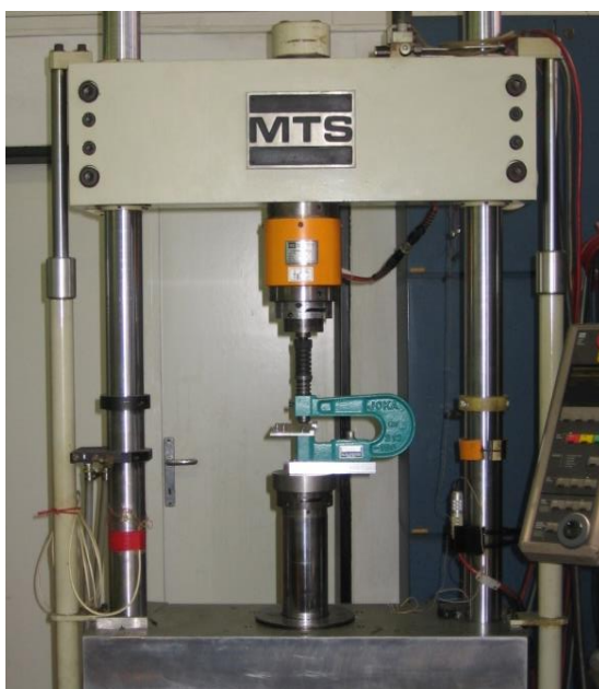
5. ábra. MTS típusú, 250 kN méréshatárú elektro-hidraulikus szakítógép a klincselő szerszámmal
