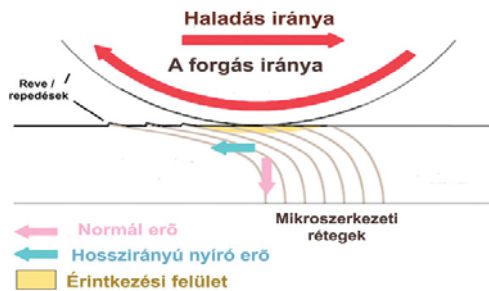
2. ábra. Repedések kialakulása a hosszirányú nyíróerők hatására [1]
